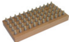
Kompletter Satz von 59 Einsätze um Zeiger zu setzen. In Hartplastik PEEK. Einsatz Ø 4.00 mm. 21 gebohrten Einsätze: Ø von 0.70 mm zu 2.50 mm. 38 vollen Einsätze: Ø von 0.30 mm zu 4.00 mm alle 0.10 mm. Anpassung Einsatz ohne Schraube oder Ø 3.00 mm auf Verlangen.
